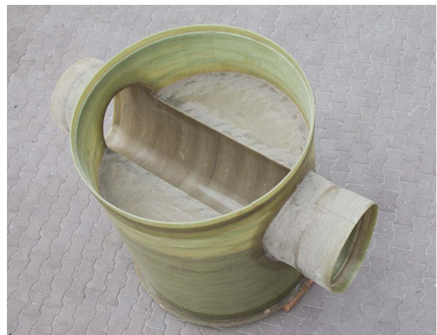
GFK Schachtherstellung für Sonderprofile
