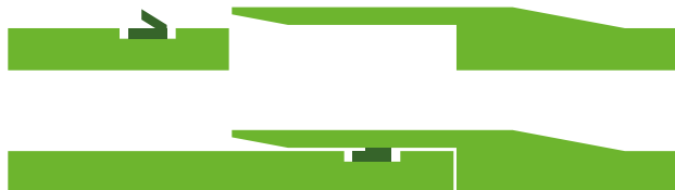
Steckverbindung mit Muffe/Spitzende/Gleitdichtung
