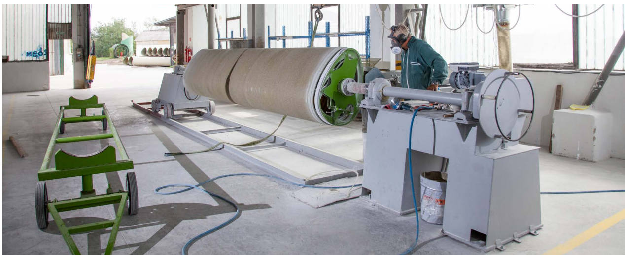
Die Rohre werden geschnitten und abgeschliffen
